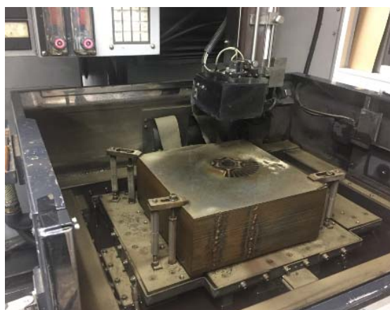
図14電磁鋼板の切り出し加工
