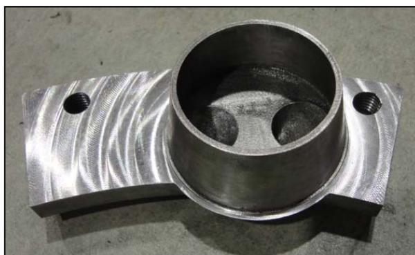
蒸気吹き出しノズル
